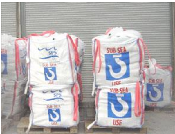
Fotografia 5. Worki wypełnione kamieniami lub żwirem
