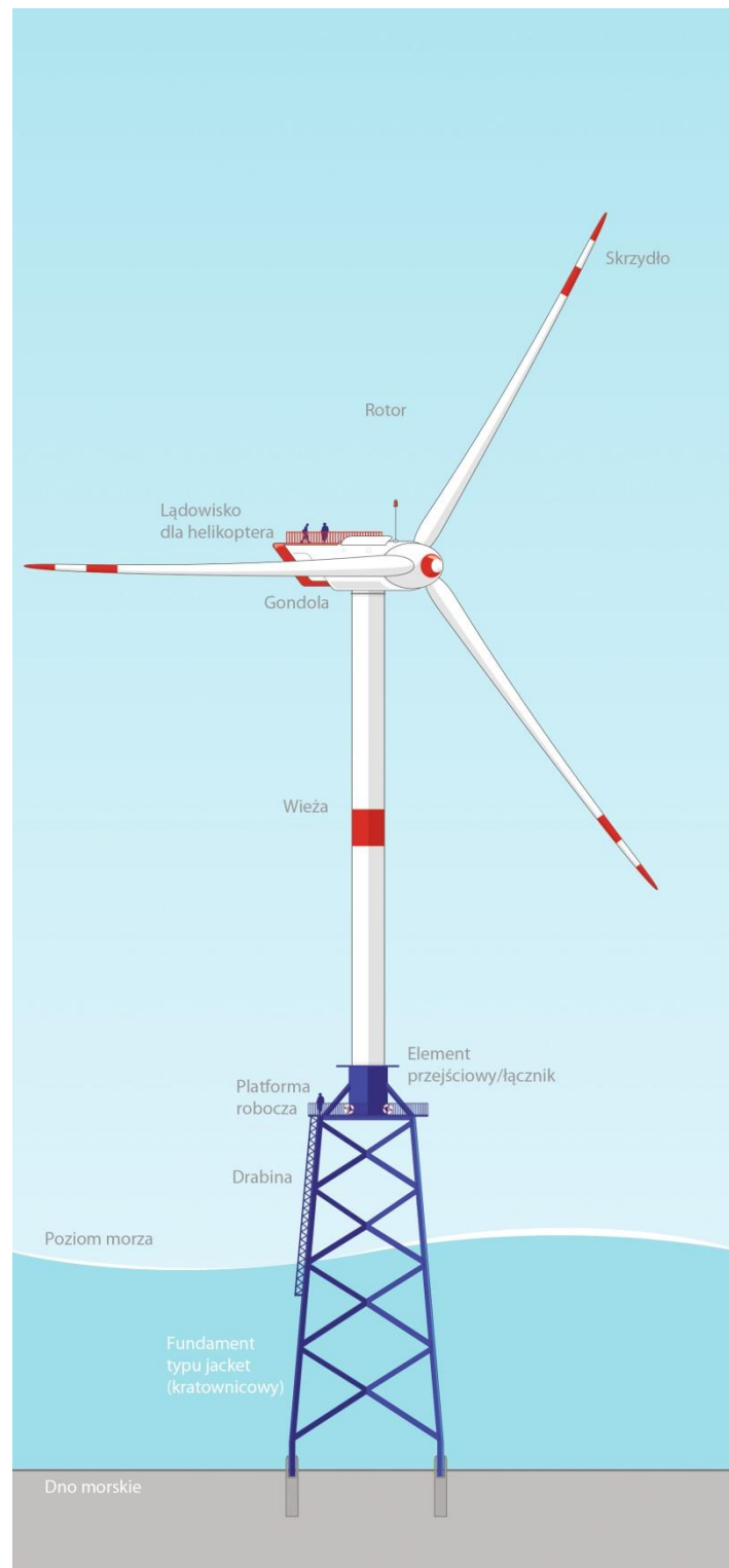
Rysunek 1. Schemat morskiej elektrowni wiatrowej
